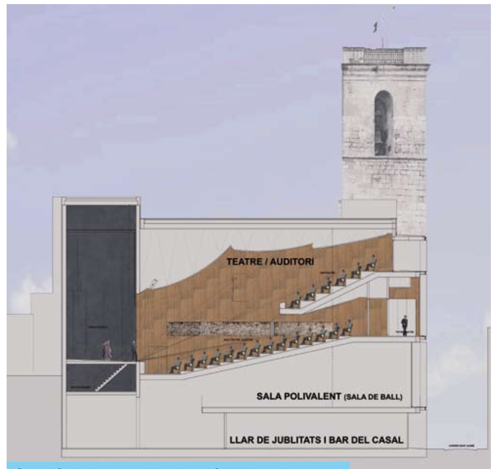
Secció de la nova distribució de l'equipament
