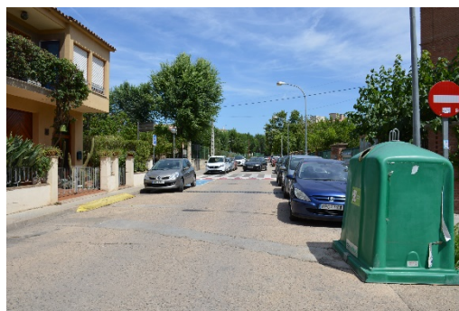
Imatge 34. Vista del C. Dr. Fleming des de la intersecció. Manca d'accessibilitats en vorera i aparcament abans de pas de vianants que dificulta la visibilitat.
